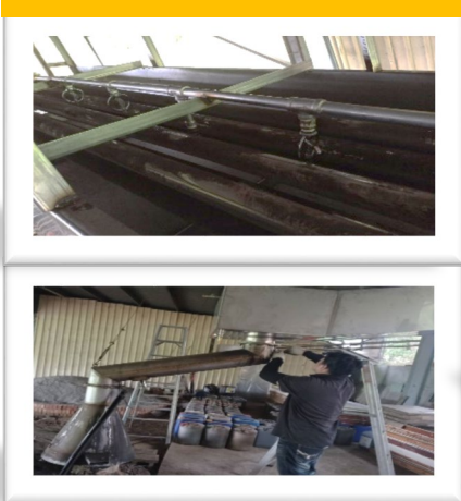
竹炭土窯水冷式尾氣收集系統
